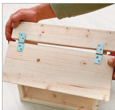
Nüüd tehke katuse valmis. Alustage sellest, et kinnitate katuseviilu külge teise viilu ülemise detaili. Naelutage detailid oma kohale.
