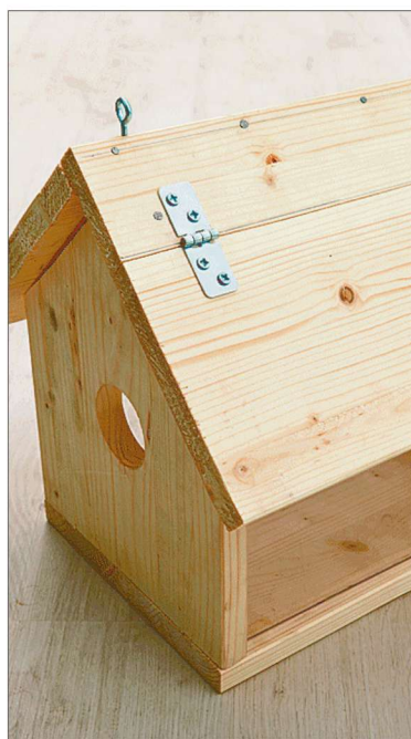
Kinnitage katusedetailide külge hinged ja veenduge, et hinged hakkavad korralikult käima.
