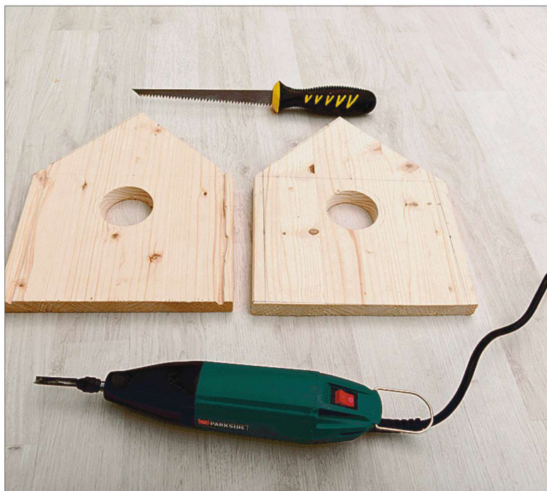
Saagige detailid välja ja lõigake otsaseintesse ümmargused avad. Süstage otsaseinte äärtesse, 5 mm kaugusele servast, 4 mm sügavused sooned, kuhu hiljem saate pleksiklaasi kinnitada. Lihvige väljapoole jäävad detailide servad liivapaberiga siledaks
