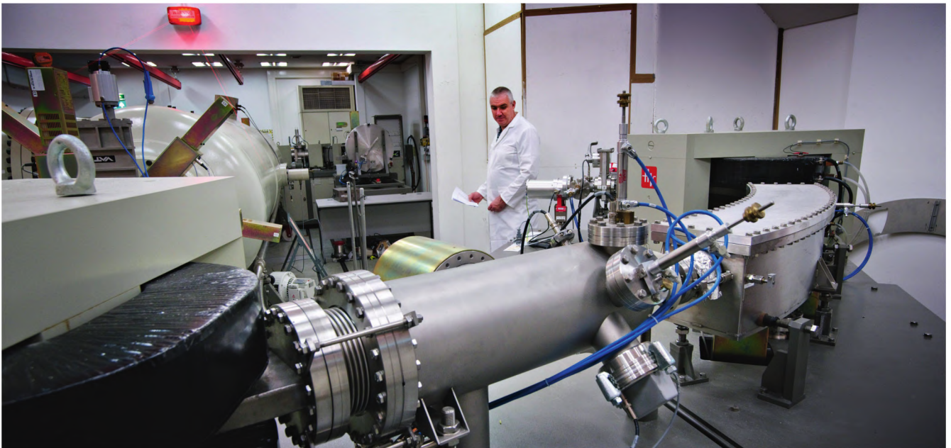
Oxfordi ülikoolis kasutatav mass-spektromeeria ehk nn AMS-seadmed objektide radiosüsiniku sisalduse määramiseks
