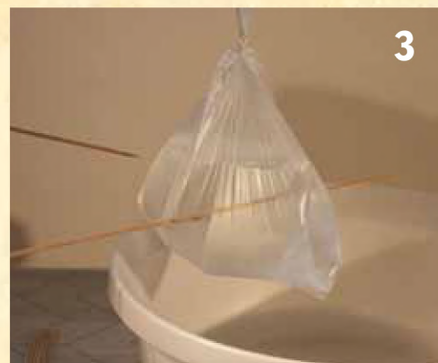
3 KUI GRILLITIKK TORGATA LÄBI KILEKOTI SELLE OSA, MIS ON VEEGA TÄIDETUD, EI LÄHE KILEKOTT KATKI.
