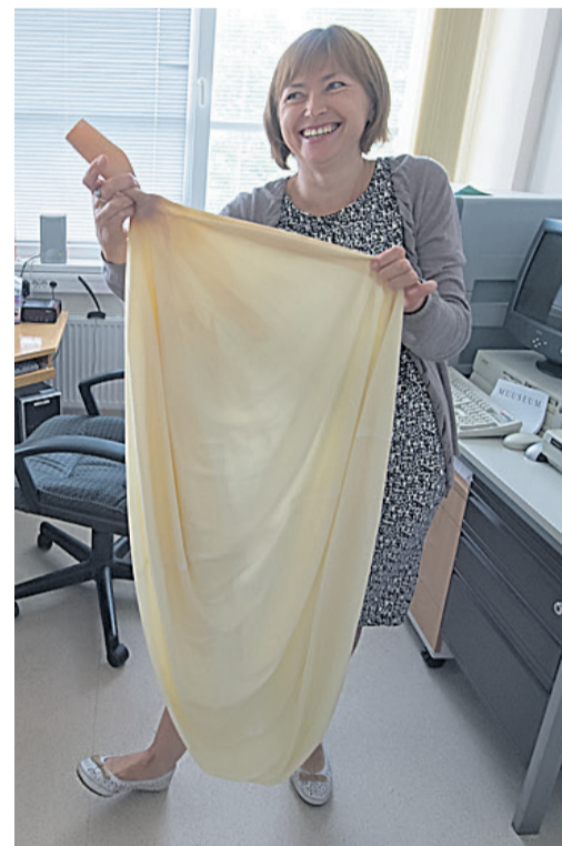
Larissa käes on raadiosondi pall, mille õhku saatmine on väga kallis. Seetõttu tehakse seda ainult üks kord ööpäevas, öösel kell 3. Palli külge kinnitatud anduriga mõõdetakse tuule suunda ja kiirust ning õhutemperatuuri ja -niiskust.
