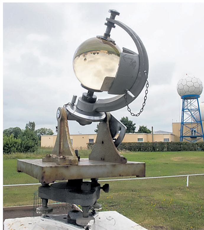
Sellise aparadiga mõõdetakse päikesepaiste kestust.
