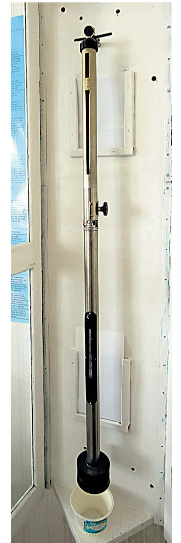
Suur baromeeter, mida kasutatakse varuvariandina. Muidu käib õhurõhu mõõtmine vaatlusväljal asuva õhurõhuanduri abil.
