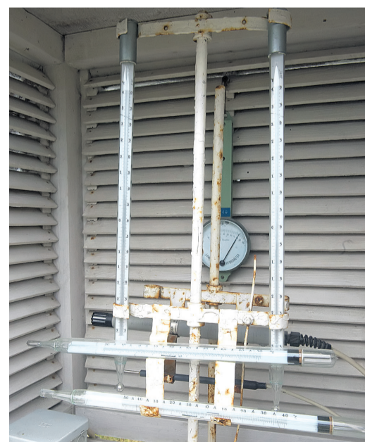
Pshührometrionn. Selles asuvad nii termomeetrid kui ka automaatjaama õhutemperatuuri andurid. Samuti asuvad selles onnis õhuniiskuse parameetreid registreerivad mõõtevahendid.
