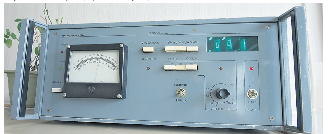
Tuulemõõtja pult, millelt saab vaadata anemorumbomeetri (tuulemõõtja) vaatlusväljal mõõdetud tuule parameetreid. Tegemist on varutuulemõõtjaga.
