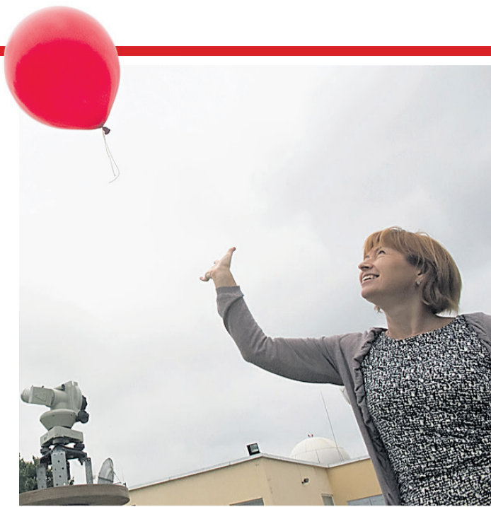
Punane pilootpall, mis tuleb õhku lasta valgel ajal – talvel kolm ja suvel viis korda päevas. Punane värv teeb selle õhus jälgimise lihtsamaks. Teodoliidiga jälgib Larissa palli kiirust ja liikumisteedkonda: nii saab mõõta tuuleparameetreid.
