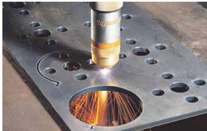
Plasmalõikus – plasmapäleti lõikab metalli.
