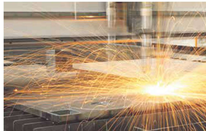
Plasmalõikusel võib plasmajoo temperatuur ulatuda kuni 28 000 °C.
