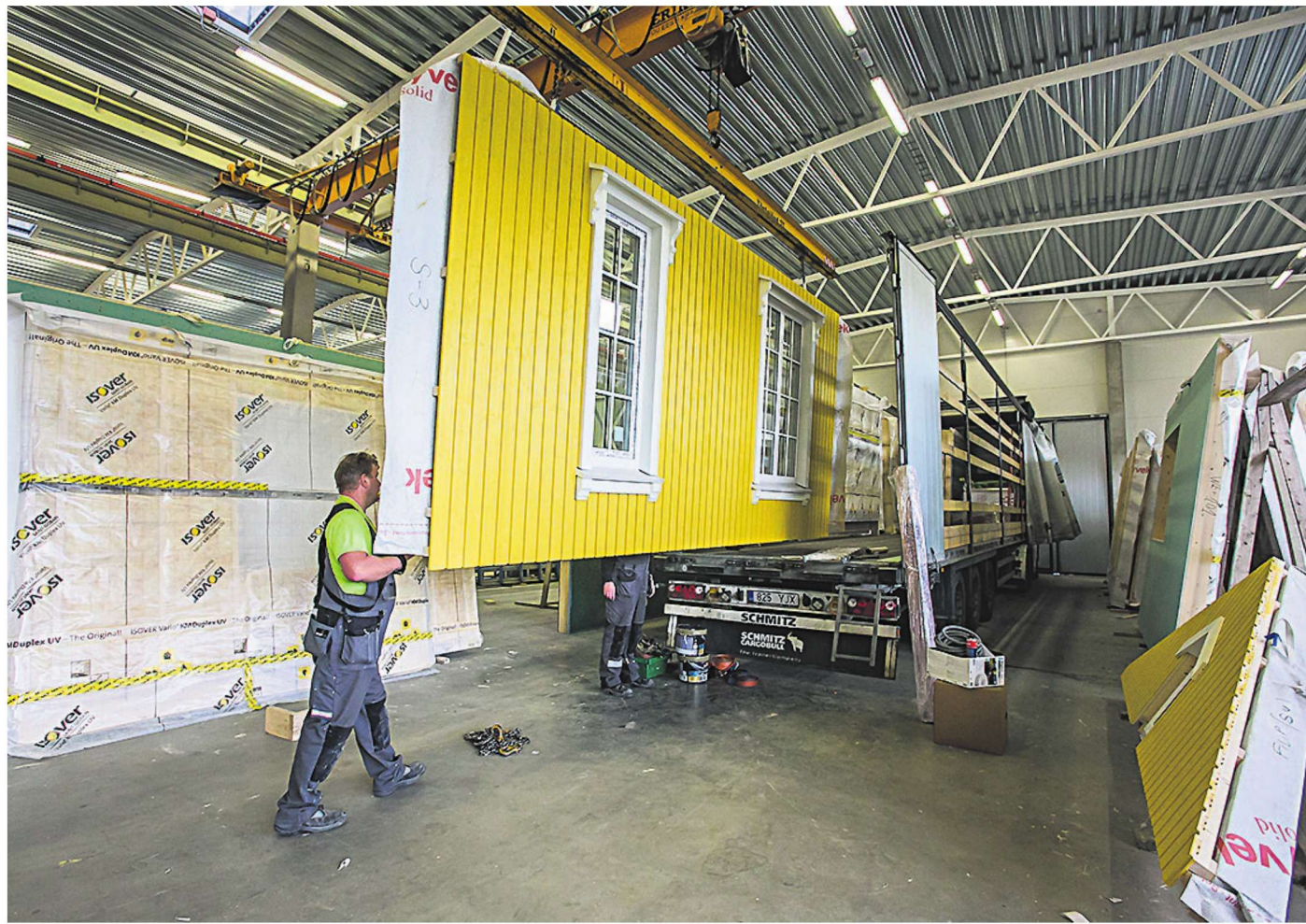
Valmis saanud seinad laaditakse auto peale ja viiakse krundile, kus maja kokku pannakse.
