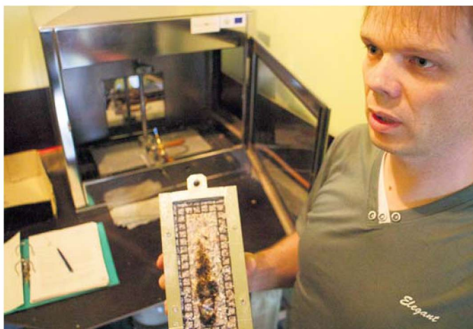
Tootmisjuht Andres Sütt näitab kohapealses ahjus, et ajalehepaberist vill on täiesti tulekindel.
